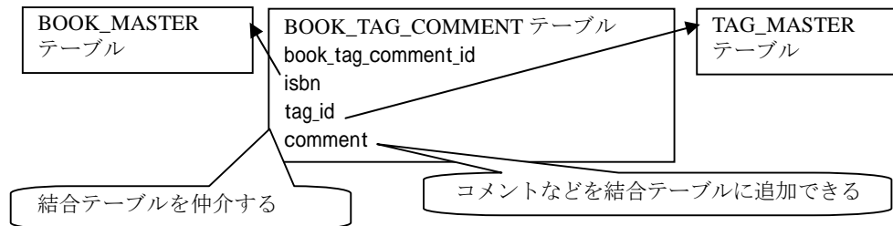
図 6-3 :through パラメータを用いた多対多
